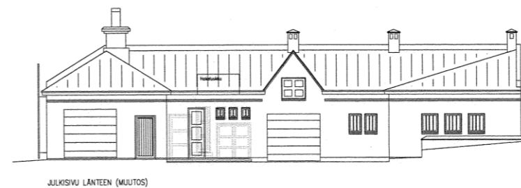
Kuva 34. Piharakennuksen muutokset vuonna 2001, hakepoltinta varten tehdään lattiaan syvennys, julkisivun aukkoja muurataan umpeen.
