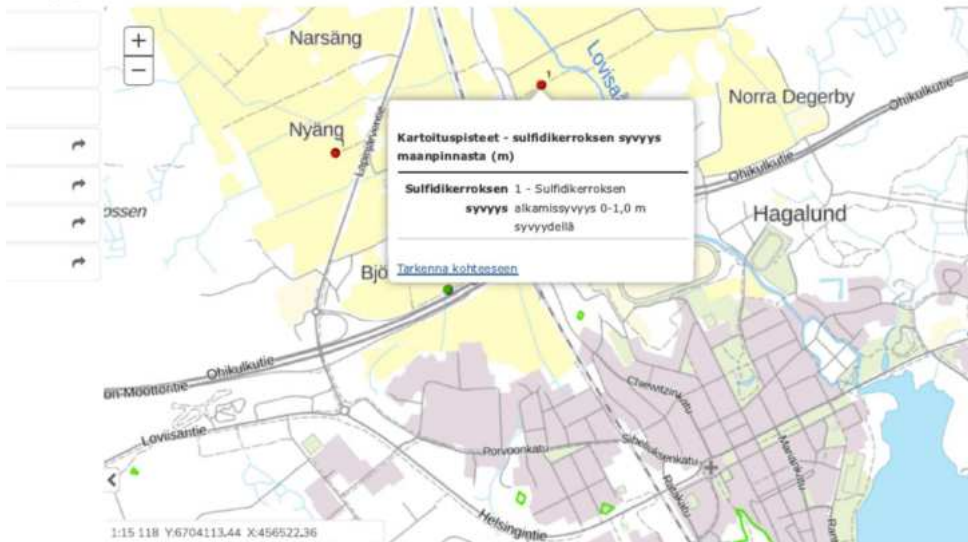
Happamat sulfaattimaat. Hankealueen pohjoispuolella on havaittu sulfidikerroksia maassa.
