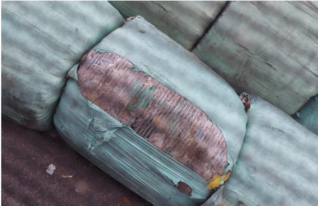
Kuva 7. Kierrätyspolttoainepaalin rikutun muovin alla näkyy tukiverkko.
