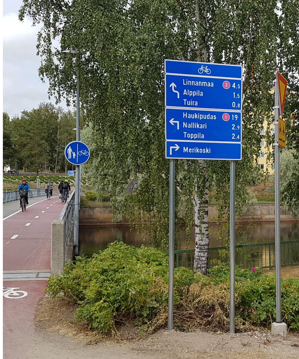
Kuva: Esimerkki pyöräliikenteen viitoituksesta Oulun Linnabaanalta.
