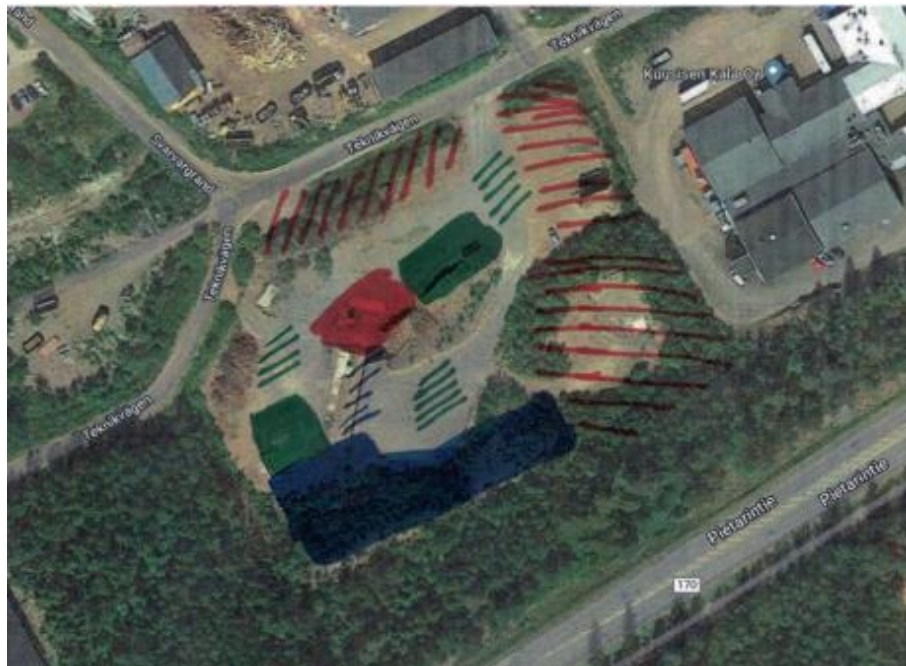
Kuva 3. Materiaaliaumat; puhdas puu (punainen raita), purkupuuh (vihreä), käsitelty CLT ym. tehdaspuumateriaali (punainen) ja kannot (sininen). Hakekoneen sijaintipaikat (vihreä raita). Betoniseinä (sininen raita).
