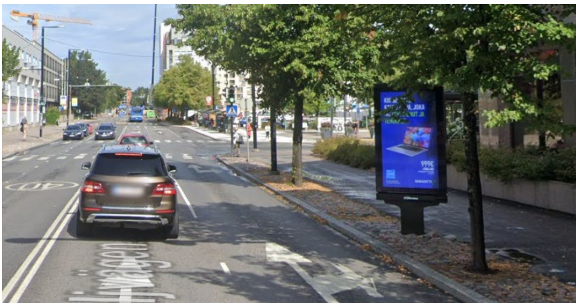
Bra exempel på reklamskylt av typ 3. Reklamskylten är placerad i en skiljeremsa med träd. Eftersom skylten är liten, dominerar den inte gatubilden eller tar bilisternas uppmärksamhet från gatukorsningen eller skyddsvägen. Bild: Vanda, Konvaljvägen. Google maps. 13.3.2024
